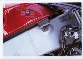
Un particolare delle viti che fissano anteriormente il serbatoio e sono accessibili dopo aver rimosso le sezioni laterali del cupolino.
