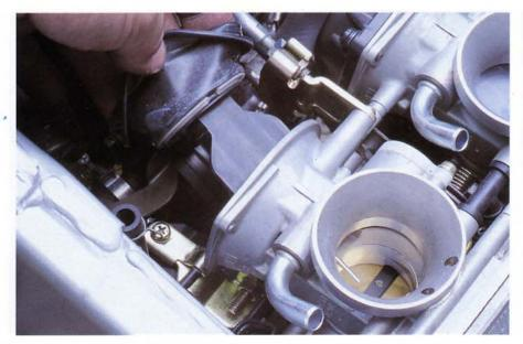
Qui a lato, per smontare le ghigliottine dei carburatori si devono staccare tutti i tubi che passano nella zona, insieme ai collegamenti elettrici della sonda di temperatura refrigerante e del potenziometro del comando gas, il cui connettore è visibile nella foto al centro.
